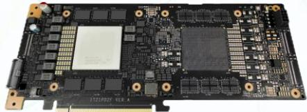
Atlas 200I SoC A1是面向边缘推理服务器市场的核心板，提供“基础通用算力+超强AI算力”。该核心板为全高全长（10.5英寸）PCIe 标卡形态，可以适配1U/2U机箱，支持客户开发自有品牌的整机，可广泛应用于OCR识别、目标识别、搜索推荐、内容审核等诸多AI应用场景。
