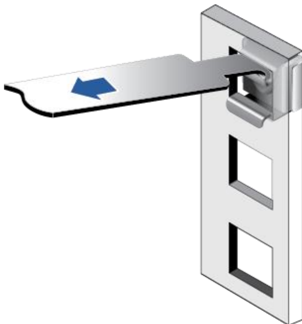
图 9-6 在机柜中安装浮动螺母
