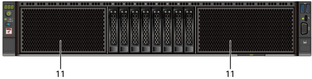
图 6-2 8x2.5 英寸硬盘配置前面板
