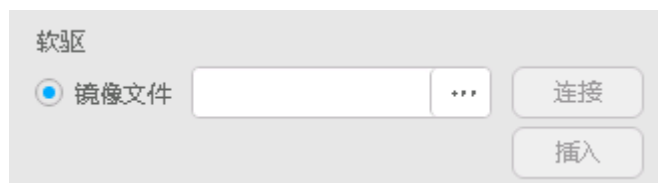
图 5-72 通过虚拟软驱挂载镜像文件
