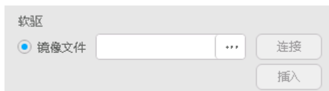
图 5-73 通过虚拟软驱挂载镜像文件
