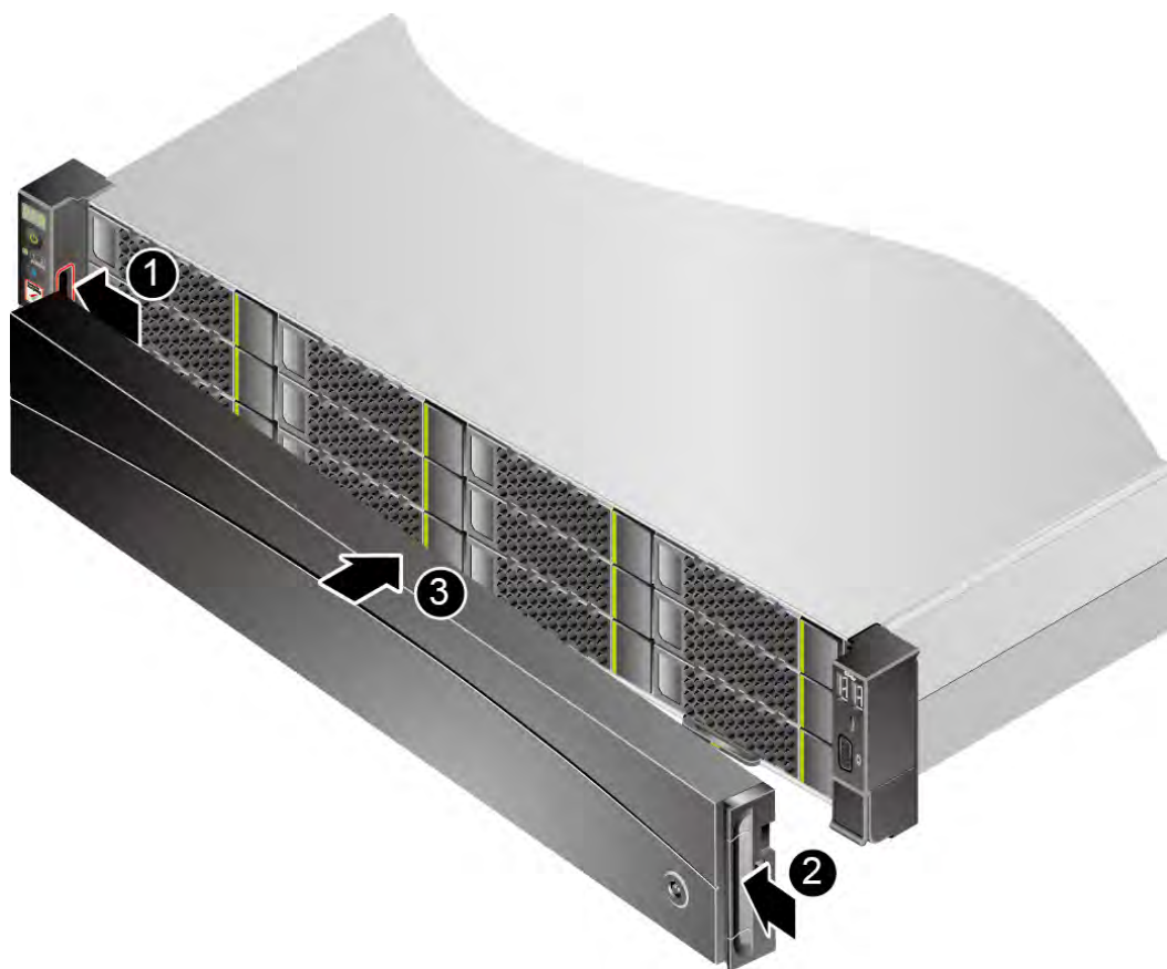
图 6-15 安装安全面板
