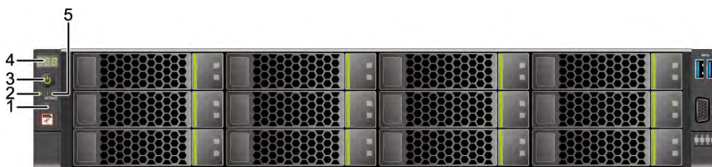
图 3-5 12x3.5 英寸硬盘配置前面板指示灯和按钮
