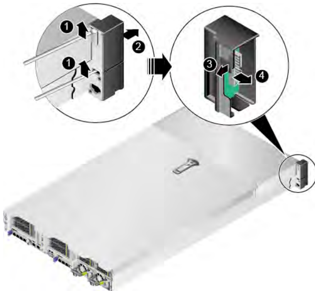
图 6-90 拆卸左挂耳板
