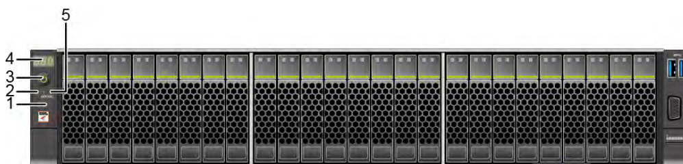
图 3-6 25x2.5 英寸硬盘配置前面板指示灯和按钮
