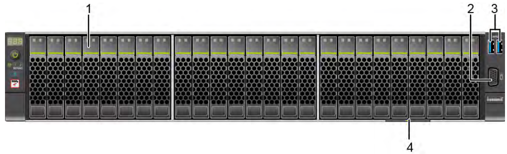
图 3-2 25x2.5 英寸硬盘配置前面板组件
