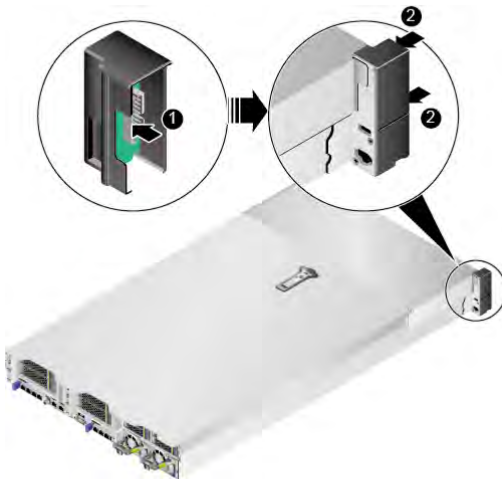
图 6-91 安装左挂耳板
